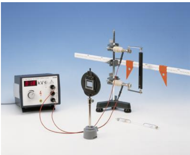
Слика 1. Експериментална апаратура за одређивање спектралних линија атома водоника
